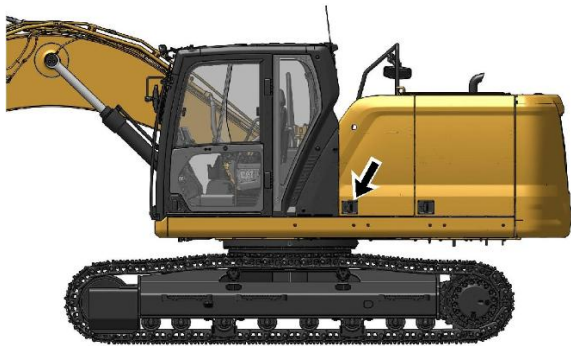
Рисунок 5 g06181546 Обеспечивает доступ к воздушному фильтру двигателя, аккумуляторным батареям и к бачку стеклоомывателя.
