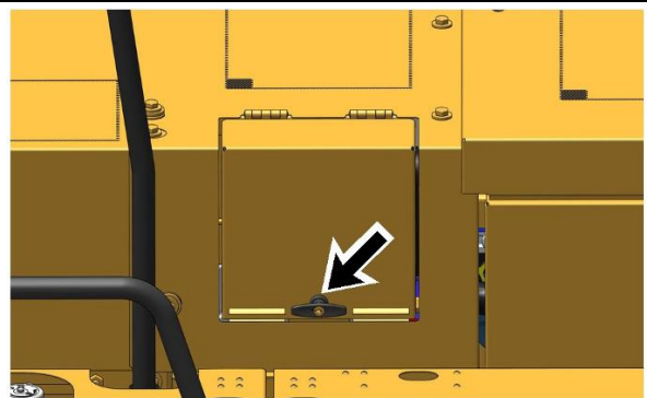
Рисунок 3 g06183460 Обеспечивает доступ к крышке наливной горловины моторного масла и верхнему щупу.
